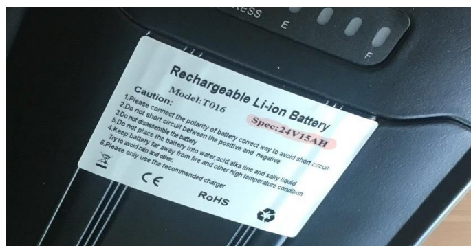
Figur 1. Exempel på elcykelbatteri med kapacitet 360 Wh.
